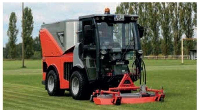
Ebenso kann ein Schlegel-, ein Böschungsmäher und ein Unkrautbesen betrieben werden.
